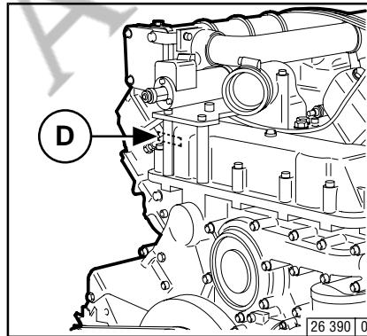
Номер двигателя **D** выбит на картере (**стрелка**), а также на фирменной табличке.
