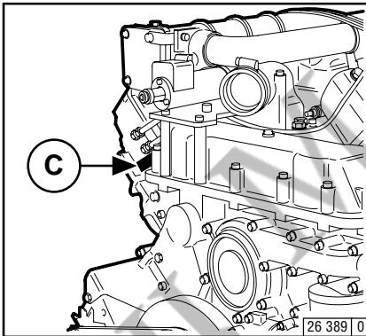
Фирменная табличка **C** закреплена на картере.
