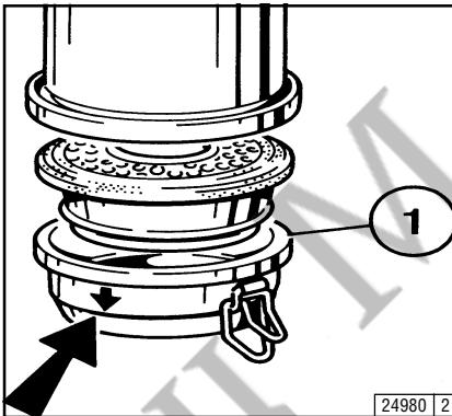
Наполнить масляную ёмкость 1 инерционно-масляного воздушного фильтра (если он пристроен) моторным маслом до маркировочной стрелки.
