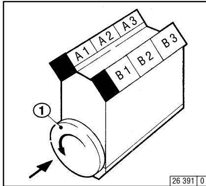
Цилиндры пронумерованы последовательно для каждого ряда А или В, начиная со стороны маховика 1.
